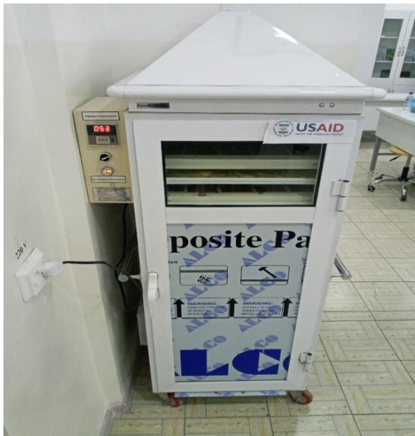
A) Quritish uskunasining tasqi ko'rinishi 1-rasm. Mevalarni quritish uskunasi
