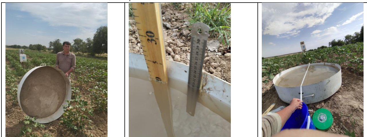
3-rasm Tajriba dalasida ochiq suv yuzasidan bo‘ladigan bug‘lanishni aniqlash jarayoni.
