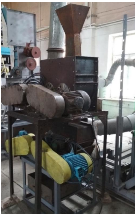
1-rasm. UChDM mashinasi laboratoriya stendining yuqori kamerasiga arra-cho‘tkali silindrlarni yig‘ilgan xolati ko‘rinishi
