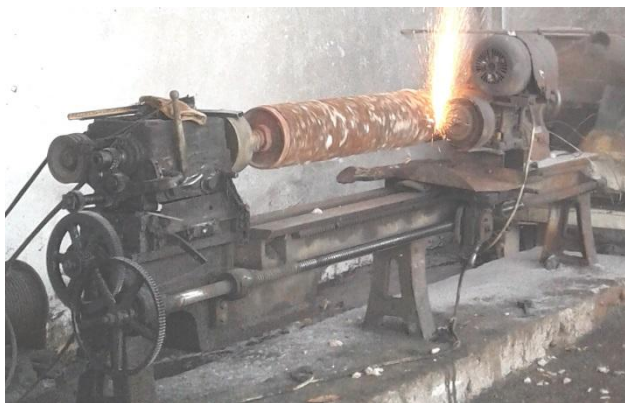
1- расм. Механика усахонасида УЧДМ русумли чигит туксизлантириш машинасининг эски чўткали вали диаметрининг силлиқланиш жараёни
